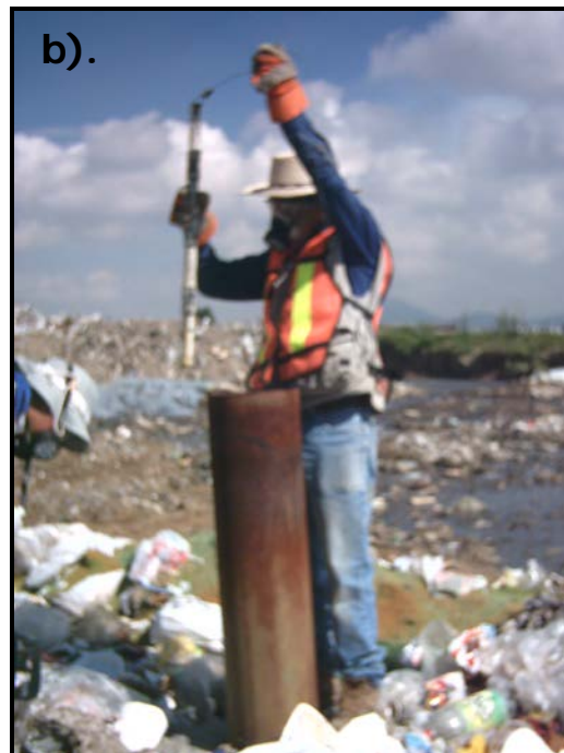
Figura 4.10 Toma de muestras en a). Los pozos de biogás al interior del vertedero; b). En los afloramientos superficiales localizados en la periferia del vertedero.
