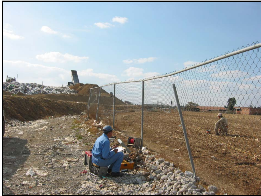
Figura 4.2 Ejecución del tendido dipolar en la porción noreste del vertedero, en la zona que comprende los terrenos de cultivo adyacentes a las fronteras externas del vertedero.
