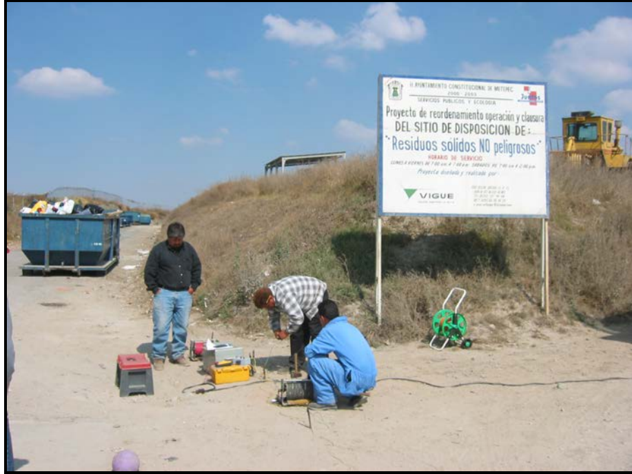
Figura 4.4 Toma de lectura para el SEV-1 realizado en la zona central del vertedero por el personal de la empresa Geofísica y Perforaciones del Medio Ambiente S.A.de C.V.
